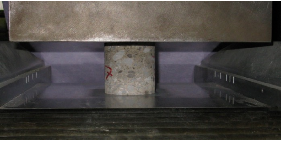
FIGUUR 18: BEPALING VAN DE DRUKSTERKTE VAN BETON OP EEN BOORKERN
