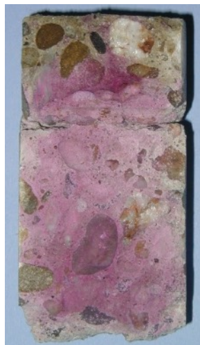
FIGUUR 15: BEPALING VAN DE CARBONATATIEDIEPTE OP EEN BOORKERN
