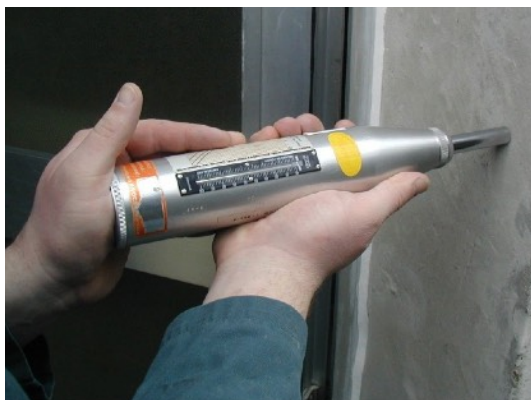
FIGUUR 14: METING VAN DE OPPERVLAKTEHARDHEID MET DE SCLEROMETER
