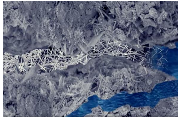
Penetron reste inactif jusqu'à la présence d'eau, déclenchant à nouveau la réaction
