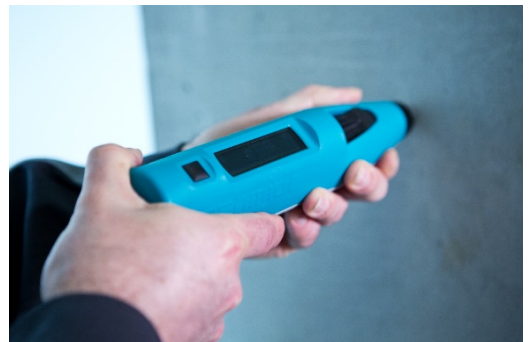
Figuur 1: Meting van de terugslagwaarde van beton met de sclerometer
