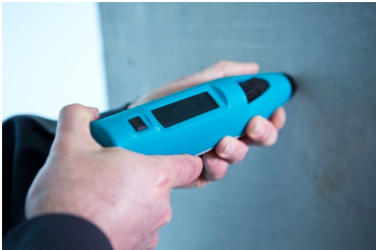
Figuur 1: Meting van de oppervlaktehardheid met de sclerometer
